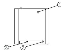
1 Aire de salida 80 mm 2 Conexión corriente 3 Conexión agua 3/4"
