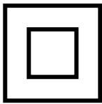
Nelle apparecchiature dotate di doppio isolamento, esso sostituisce completamente la misura preventiva della messa a terra. Le apparecchiature a doppio isolamento riportano il relativo simbolo (due quadrati concentrici).
