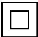
In einem doppelt isolierten Gerät wird eine doppelte Isolierung anstatt einer Erdung verwendet. Das Symbol (Quadrat in einem Quadrat) ist auf dem Typenschild vermerkt.
