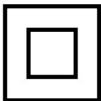
Cet appareil est muni d'une double isolation. Dans un appareil à double isolation, deux isolations distinctes remplacent la mise à la terre.. Le symbole - (carré dans un carré) peut aussi figurer sur l'appareil. L'appareil n'est pourvu d'aucun dispositif de mise à la terre et un tel dispositif ne doit pas être ajouté.
