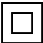
Bij een dubbel geïsoleerd apparaat wordt gebruik gemaakt van dubbele isolering in plaats van aarding. Een dubbel geïsoleerd apparaat kunt u herkennen aan het symbool voor dubbele isolering (een vierkant in een vierkant) op het etiket met gegevens.
