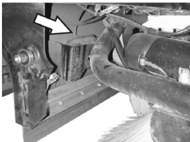
Slangetilkobling for undertrykksslange for senking av sidebørster
