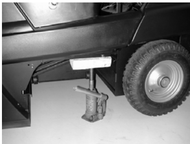
Aufnahmepunkt für Wagenheber (Hinterräder)
