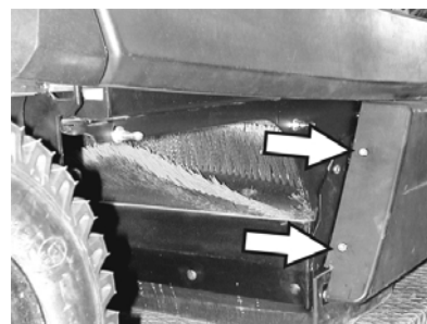
Slangetilslutningerne til undertrykspumpen og undertryksdåsen (lager)
