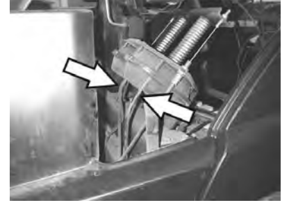
وصلات خراطيم إلى وحدة تفريغ خاصة بإنزال بكرة الكنس
