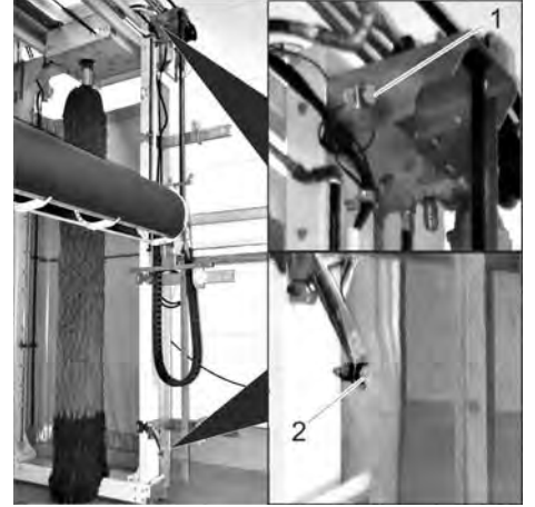
صورة 7 1. المفتاح الحدي لكمرة سقف الضغط العالي بأعلى (HdO) 2. المفتاح الحدي لكمرة سقف الضغط العالي بأسفل (HdU)
