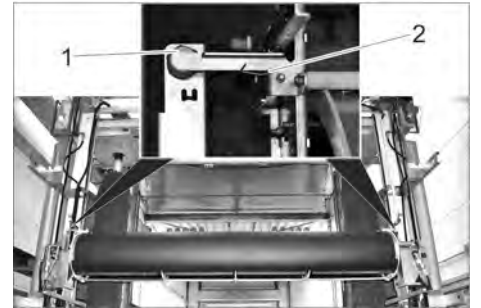
صورة 8 1. المفتاح الحدي لمفتاح أمان كمرة سقف الضغط العالي 2. نابض
