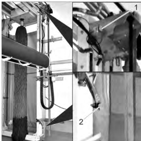
Obr. 7 1 Koncový spínač vysokotlaké střešní lišty nahoře (HdO) 2 Koncový spínač vysokotlaké střešní lišty dole (HdU)
