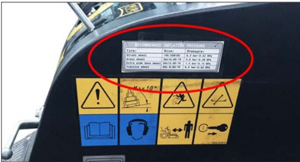
Rysunek: Naklejka w kabinie kierowcy z informacją o zalecanych ciśnieniu w oponach
