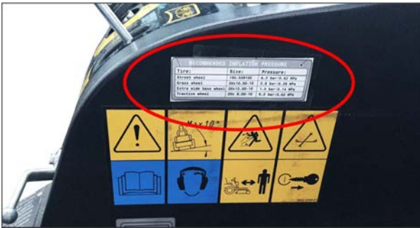
Малюнок: Наклейка у кабіні водія з рекомендованим тиском у шинах
