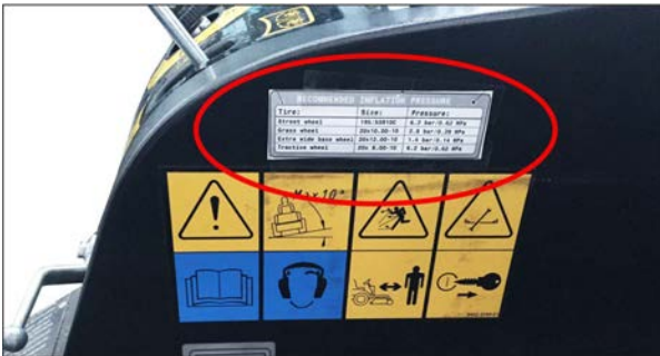
Obrázok: Nálepka v kabíne vodiča s odporúčaným tlakom v pneumatikách
