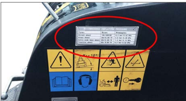
Slika: Nalepka v voznikovi kabini s priporočenimi tlaki v pnevmatikah
