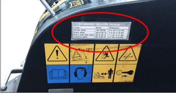
Şekil: Sürücü kabiniinde tavsiye edilen lastik basınçlarının yazıldığı etiket
