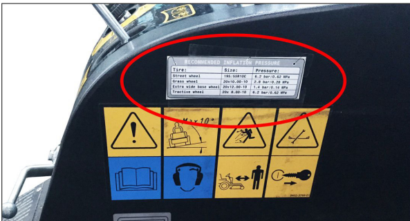
Afbeelding: Sticker in de bestuurderscabine met aanbevolen waarden voor de bandendruk
