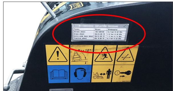
Slika: Nalepnica u kabini vozača sa preporučenim pritisima punjenja
