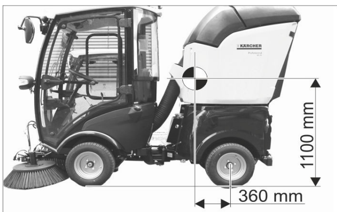
Poloha ťažiska pri plne naloženom prístroji.
