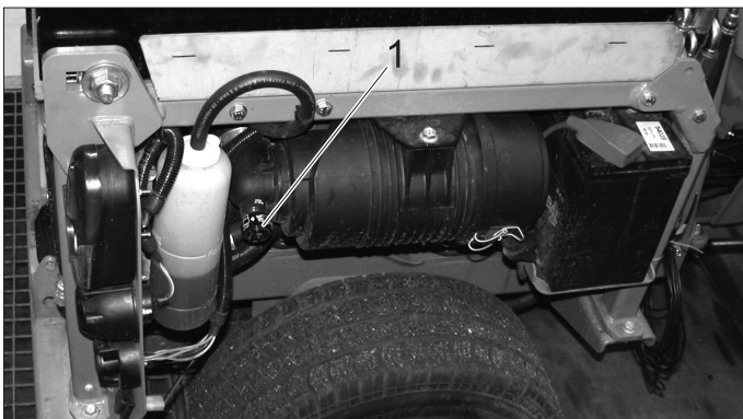
1 Zobrazenie výmeny vzduchového filtra
