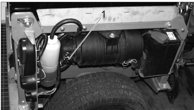
1 Prikaz menjave zračnega filtra
