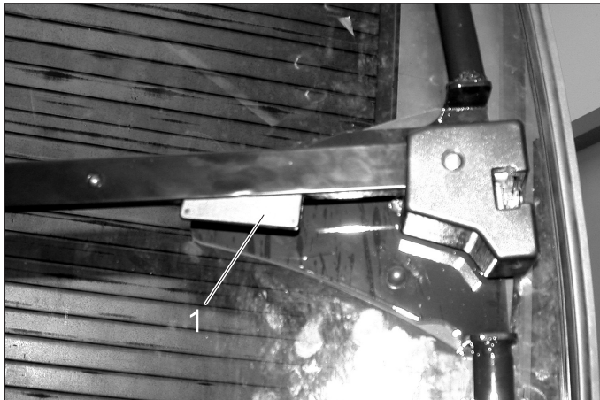
1 Sistem interior de deblocare ușă
