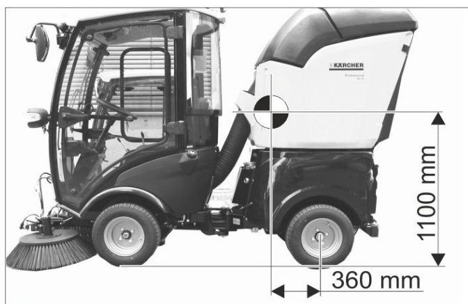
Těžiště při plně naloženém přístroji.
