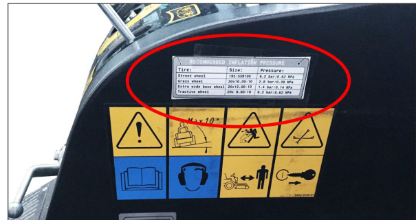
Figura: Autocolante na cabina do condutor com pressão recomendada para os pneus
