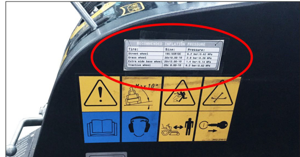
Afbeelding: Sticker in de bestuurderscabine met aanbevolen waarden voor de bandendruk
