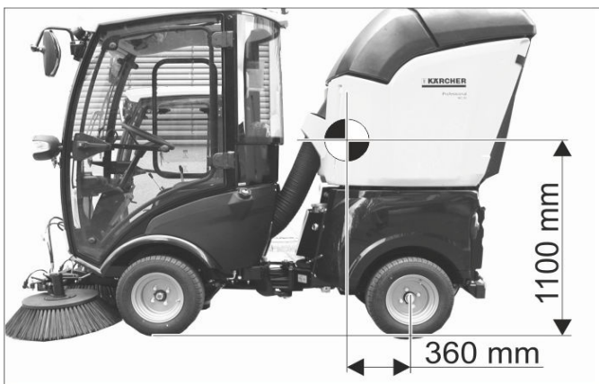
Positie zwaartepunt bij volledig geladen apparaat.
