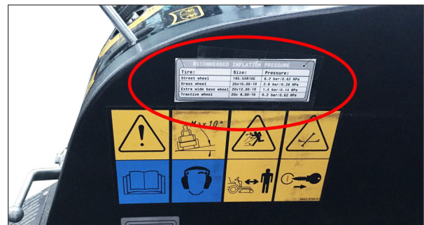
Εικόνα: Αυτοκόλλητη ετικέτα στην καμπίνα οδηγού με τις προτεινόμενες πιέσεις ελαστικών
