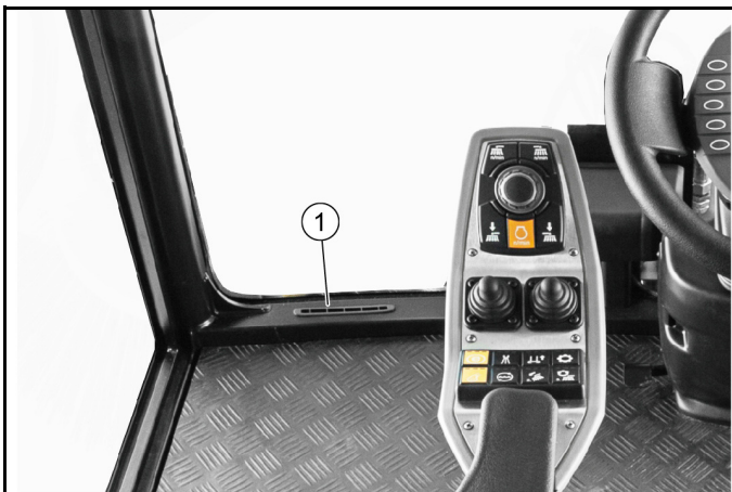
① Luftkanal fotbrønn
