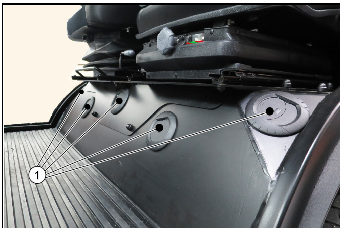
① Вентиляционные сопла
