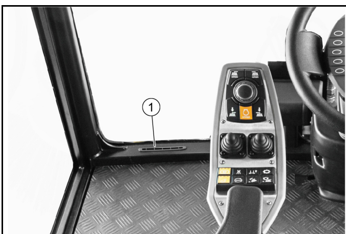
① Воздушный канал в пространстве для ног
