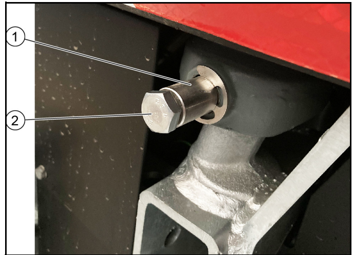
Figura: Variante B con dado di sicurezza lungo
