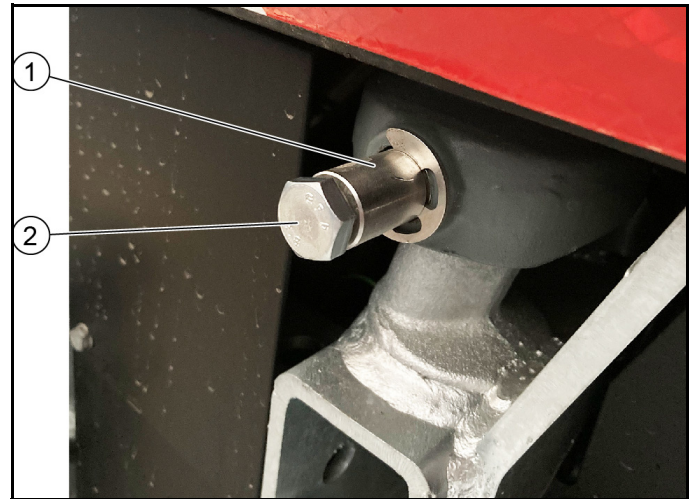
Abbildung: Variante B mit langem Sicherungsbolzen
