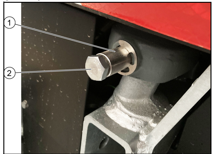
Figura: Variante B com perno de segurança comprido
