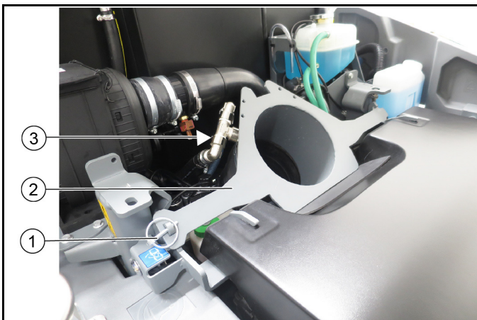
Afbeelding: Veegsysteem met wisselwagen (afgebeeld zonder zuigmond)
